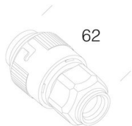
372 Presa per innesto rapido
