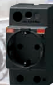
Presa con fusibile: consente di collegare strumenti di controllo e manutenzione al quadro evitando lo scatto degli interruttori a protezione del quadro stesso in caso di cortocircuito dello strumento in uso e risparmiando una protezione dedicata per la presa.
