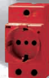
Presa rosso RAL 3000: segnala l'alimentazione a monte di un UPS che garantisce la continuità di servizio anche in caso di black-out temporanei.
