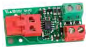
Interfaccia BUS XIB (nel caso si utilizzi la scheda E024S con fotocellula non BUS) Codice articolo 790062
