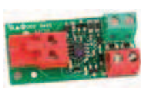
Interfaccia BUS XIB (per scheda E045 o E024S con fotocellula no BUS)
