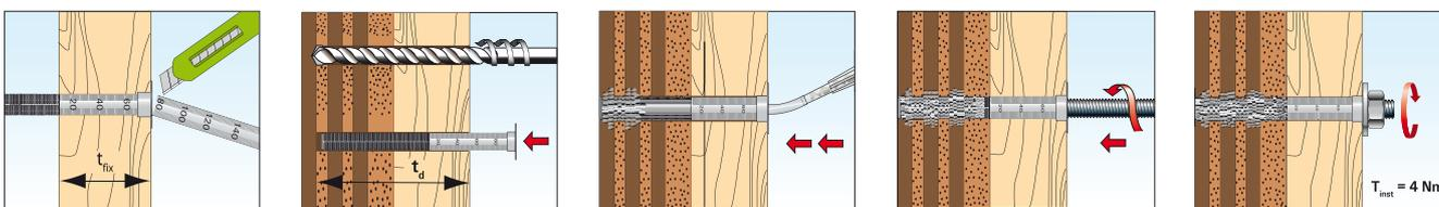
Si raccomanda un'accurata pulizia del foro prima dell'installazione.
