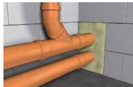
Riempimento di attraversamenti di tubazioni
