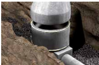
Sigillatura anelli di pozzetti di calcestruzzo
