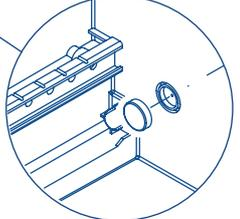
Forare diametro 8-8,5 e tappare per scarico condensa.
