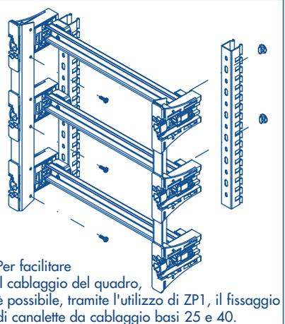
Per facilitare il cablaggio del quadro, è possibile, tramite l'utilizzo di ZP1, il fissaggio di canalette da cablaggio basi 25 e 40.
