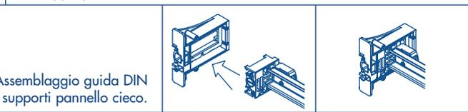
Assemblaggio guida DIN con supporti pannello cieco.
