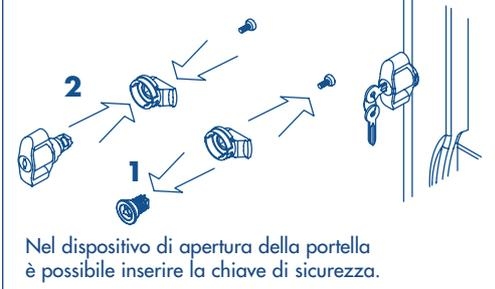
Nel dispositivo di apertura della portella è possibile inserire la chiave di sicurezza.
