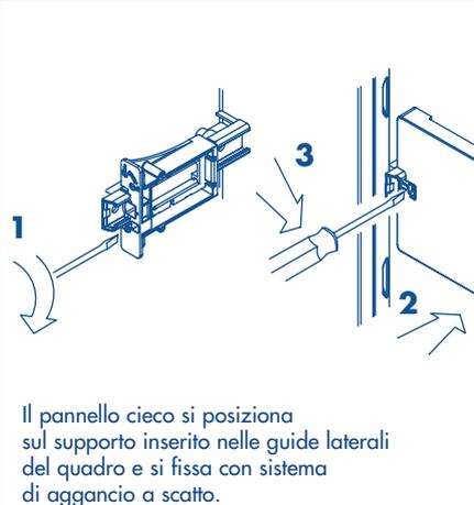
Il pannello cieco si posiziona sul supporto inserito nelle guide laterali del quadro e si fissa con sistema di aggancio a scatto.
