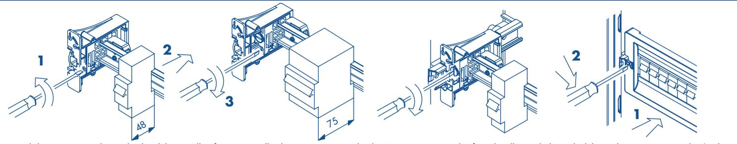
E' possibile posizionare la guida din del pannello sfenestrato nelle due posizioni standard (48 e 75 mm) nonché fissarla alle guide laterali del quadro tramite vite ad 1/4 di giro. Il pannello sfenestrato si posiziona sulla guida din bloccandolo con sistema di aggancio a scatto.
