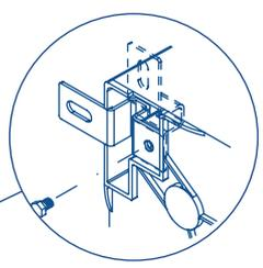
Le staffe di fissaggio consentono l'installazione del quadro senza alcun foro dello stesso garantendo così il doppio isolamento. ☐
