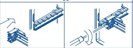
Fissaggio guida DIN sulle guide del quadro tramite vite a 1/4 di giro.
