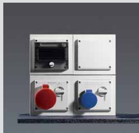
Esempio di installazione ad incasso (sotto traccia): centralino portapparecchi, scatola di derivazione e prese interbloccate Serie OMNIA. Esecuzione a tenuta stagna: IP55.
