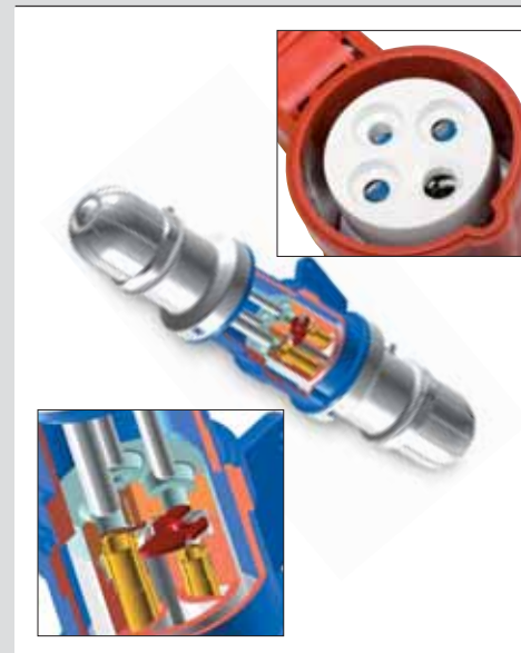
Otturatore di protezione alveoli per aumentare la sicurezza contro i contatti diretti. (Dispositivo di sicurezza SAFE-IN).
