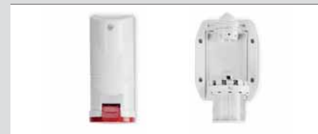
Esecuzione BASE: cablaggio facilitato. Presa fissata alla base, morsetti aperti orientati e facilmente accessibili.
