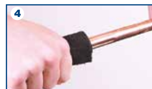
4 Pulire la superficie esterna del tubo
