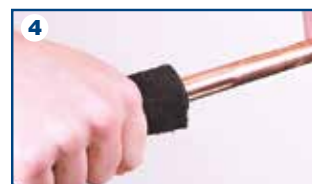
4 Pulire la superficie esterna del tubo
