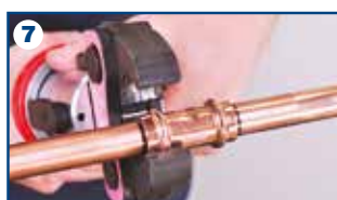
7 Completare il ciclo di pressatura. Pressare una sola volta
