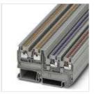
Morsetti per sensori e attuatori, Collegamento: Connessione Push-in, Sezione:0,14 mm<sup>2</sup> - 1,5 mm<sup>2</sup>, AWG: 26 - 14, Larghezza: 3,5 mm, Colore: grigio, Tipo di montaggio: NS 35/7,5, NS 35/15
