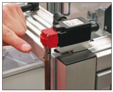
Bloccaggio temporaneo dell'albero (grano in dotazione).
