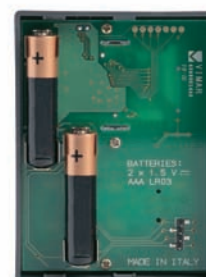
Vista interna del termostato dal retro, con alloggiamento batterie
