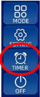
Selezionando l'opzione **Timer** si possono rendere operative fino a 3 fasce orarie per riscaldamento/raffreddamento e per acqua sanitaria dove possono essere inserite temperature di set point diversi per specificato in quali giorni della settimana. (vedi istruzioni in **Manuale Tecnico di Installazione (MTI)** )
